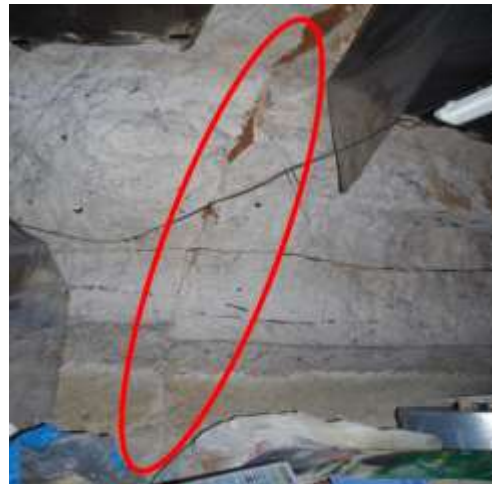
Photographie 8 : Diaclase à épontes fermées et remplissage argileux
