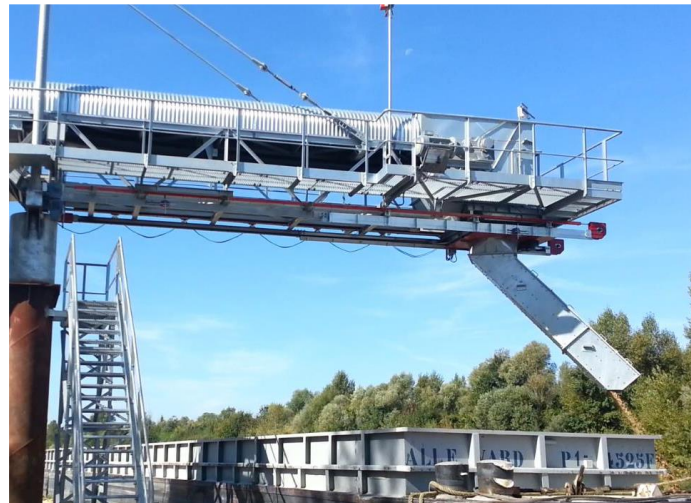
Figure 7 : Goulotte de jetée articulée non translatable (Photo : Techmi)
