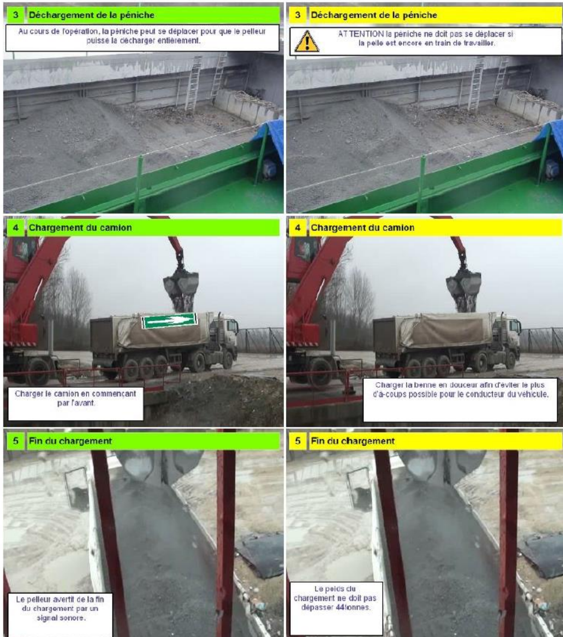
Figure 50 : Mode opératoire de déchargement de la péniche.
