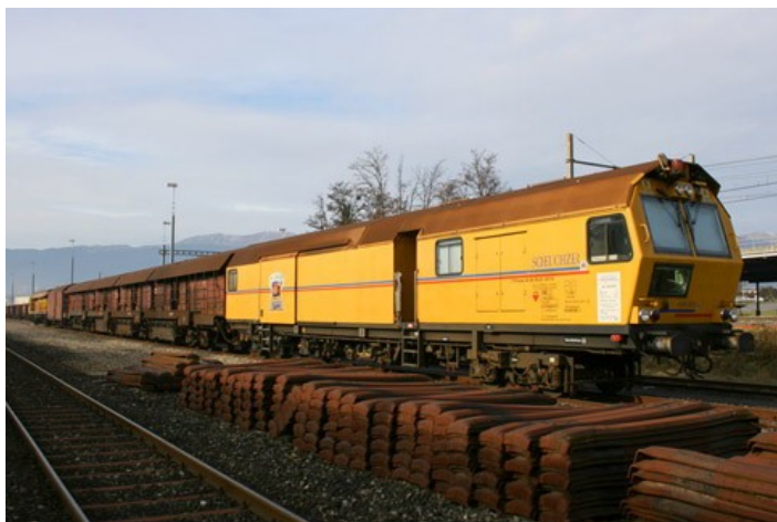
Train meuleur de rails (Scheuchzer S.A.)
