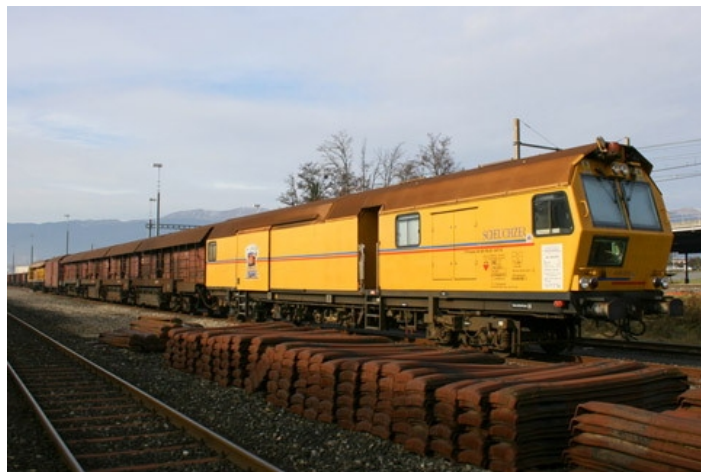
Train meuleur de rails (Scheuchzer S.A.)
