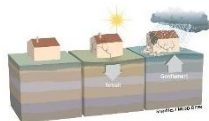
Retrait-gonflement des argiles
