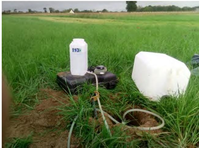
Figure 3 - Illustration d'un test de perméabilité
